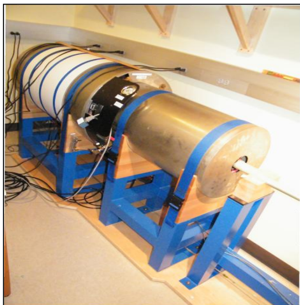
Figura 5.5. Magnetómetro criogénico, donde se realizaron mediciones de NRM y ARM.
