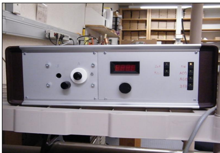
Figura 5.6. Magnetómetro de pulso utilizado para mediciones de IRM, el campo máximo que alcanza es de 3 T.
