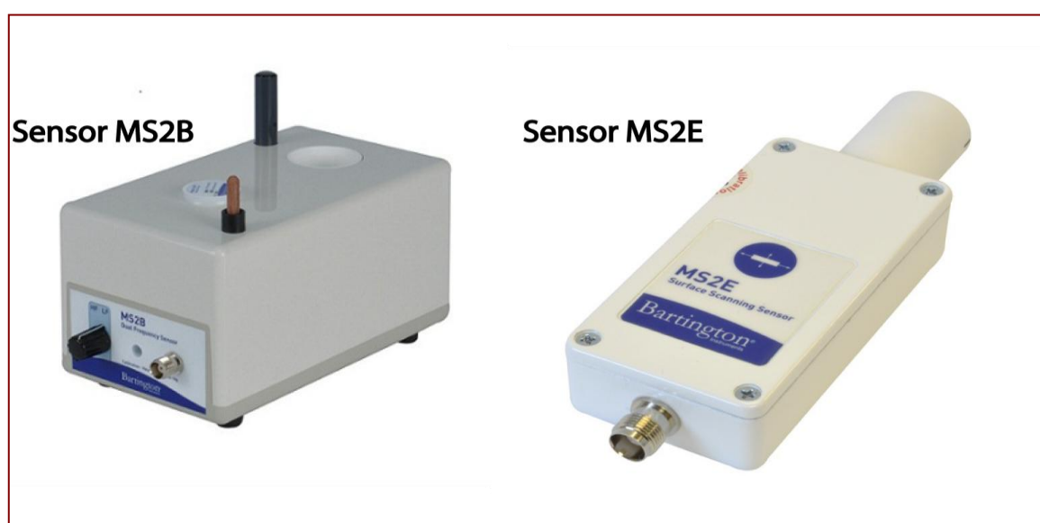
Figura 5.4. Sensores Bartington Ms2b utilizado para mediciones de susceptibilidad de baja resolución y sensor MS2E utilizado para mediciones de susceptibilidad de alta resolución.
