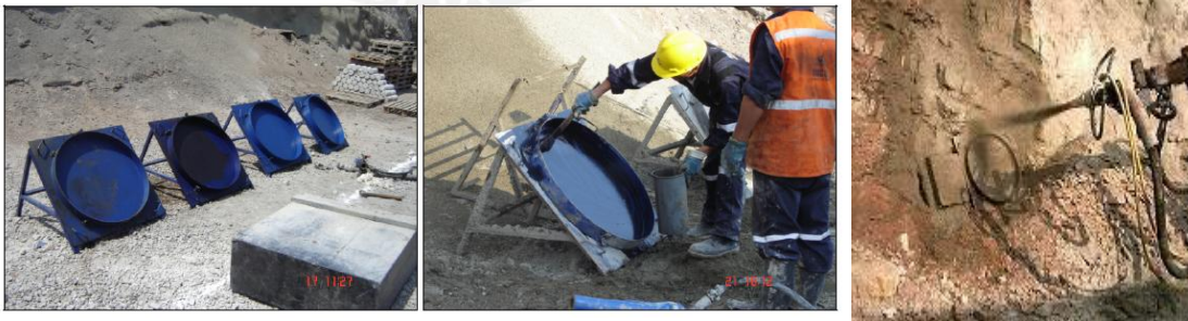
Ensayo de paneles circulares.
