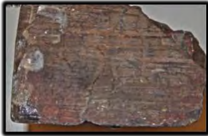
Figura 2.16 Limolita (Laboratorio de petrología, F.I.).
