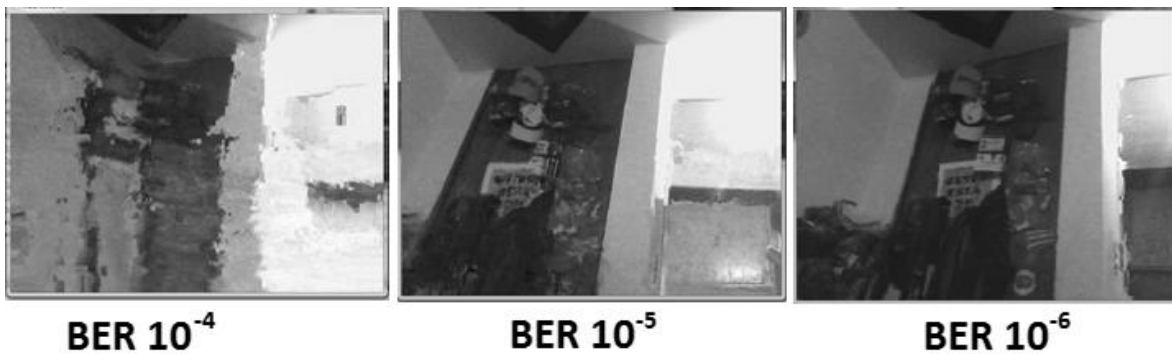
FIGURA 5. 41 RESULTADOS DE LA SIMULACIÓN DE LA TRANSMISIÓN DE UN ARCHIVO DE VIDEO SOBRE UN CANAL SIMÉTRICO BINARIO CON DISTINTOS BER
