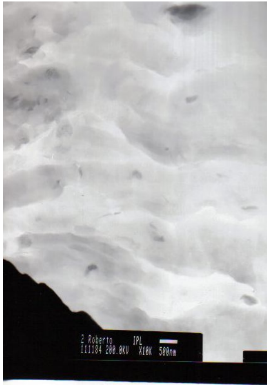
Imágenes TEM de los compuestos PEAD-MAH con 6% de Arcilla Modificada a) Morfología General del material b) Detalle de la lamilla de Arcilla en la Matriz Polimérica
