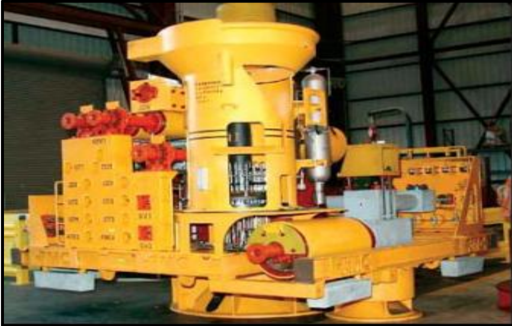
Figura 3.22 Árbol de producción submarino
