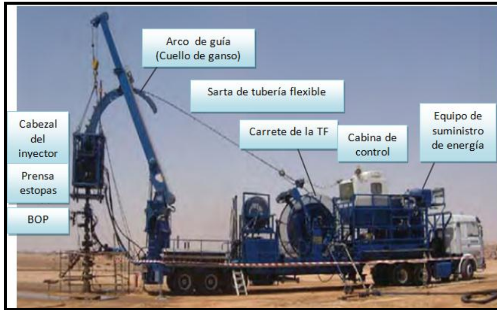
Figura 3.8 Equipo de Tubería Flexible
