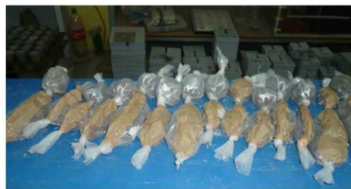
Fotos a) y b) Tendido de muestras alteradas obtenidas de los sondeos de penetración estándar para clasificación visual y al tacto
