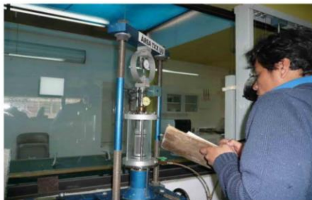
Fotos e) y f) Toma de lecturas en los micrómetros de carga y deformación, correspondientes al ensayo de compresión triaxial
