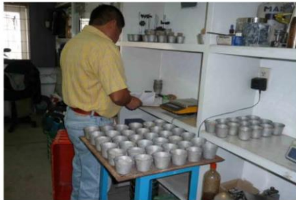
Fotos c) y d) Determinación del contenido de humedad en las muestras de suelo, mediante el pesado en estado húmedo y seco. Enfriado de muestras para la determinación de la densidad de los sólidos
