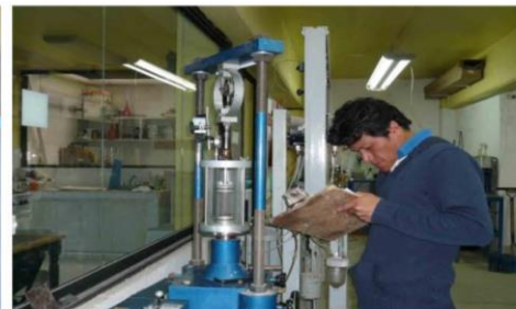
Fotos e) y f) Toma de lecturas en los micrómetros de carga y deformación, correspondientes al ensayo de compresión triaxial
