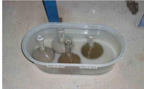
Fotos c) y d) Determinación del contenido de humedad en las muestras de suelo, mediante el pesado en estado húmedo y seco. Enfriado de muestras para la determinación de la densidad de los sólidos
