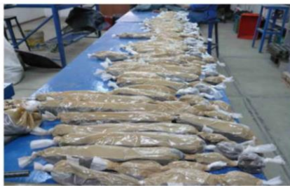
Fotos a) y b) Tendido de muestras alteradas obtenidas de los sondeos de penetración estándar para clasificación visual y al tacto
