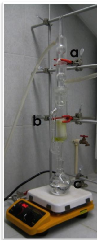
Fig.8. Partes del soxhlet, a) Refrigerante, b) Sifón y c) Matraz redondo de fondo plano.
