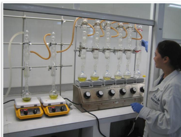
Fig.9. Extracción por Soxhlet durante 12 horas.
