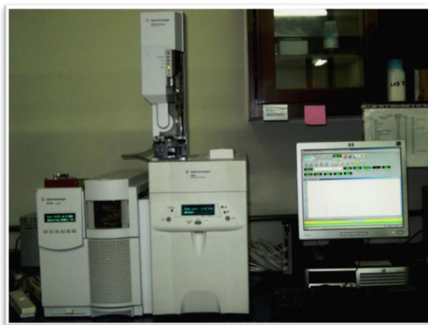
Fig.13. Cromatógrafo de gases acoplado al espectrómetro de masas.
