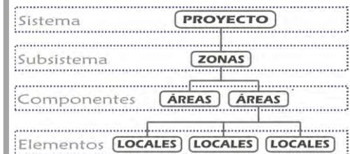
Estructura esquemática de un árbol de sistemas
