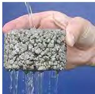
El concreto ecológico tiene un gran contenido de vacíos en su estructura de composición del 15% al 30% que permite el paso del agua dentro del material sin perder sus características de resistencia a la compresión y flexión.
