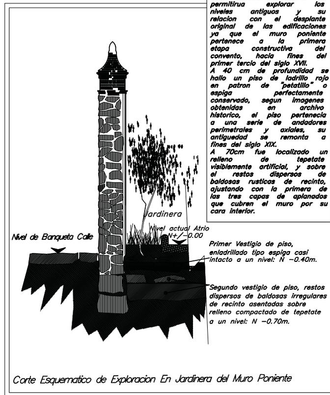
Corte Esquemático de Exploración En Jardinera del Muro Poniente
