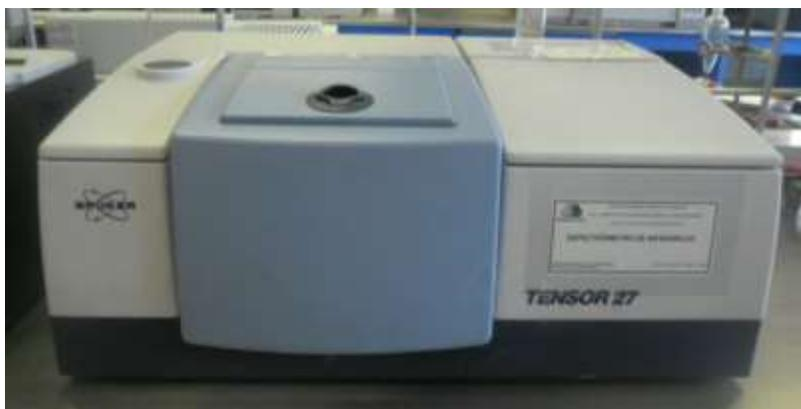
**Figura 12. Espectrofotómetro de Infrarrojo marca BRUKER, modelo TENSOR 27.**
