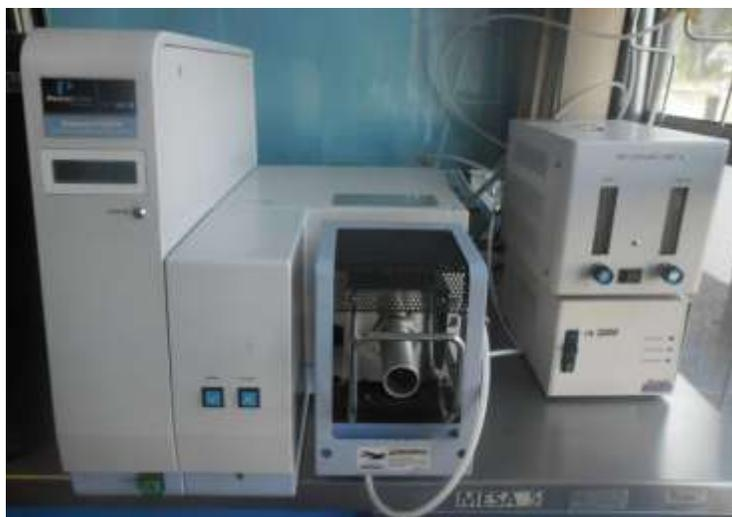
**Figura 13. Analizador de TG/DTA marca PerkinElmer, modelo Diamond TG/DTA.**
