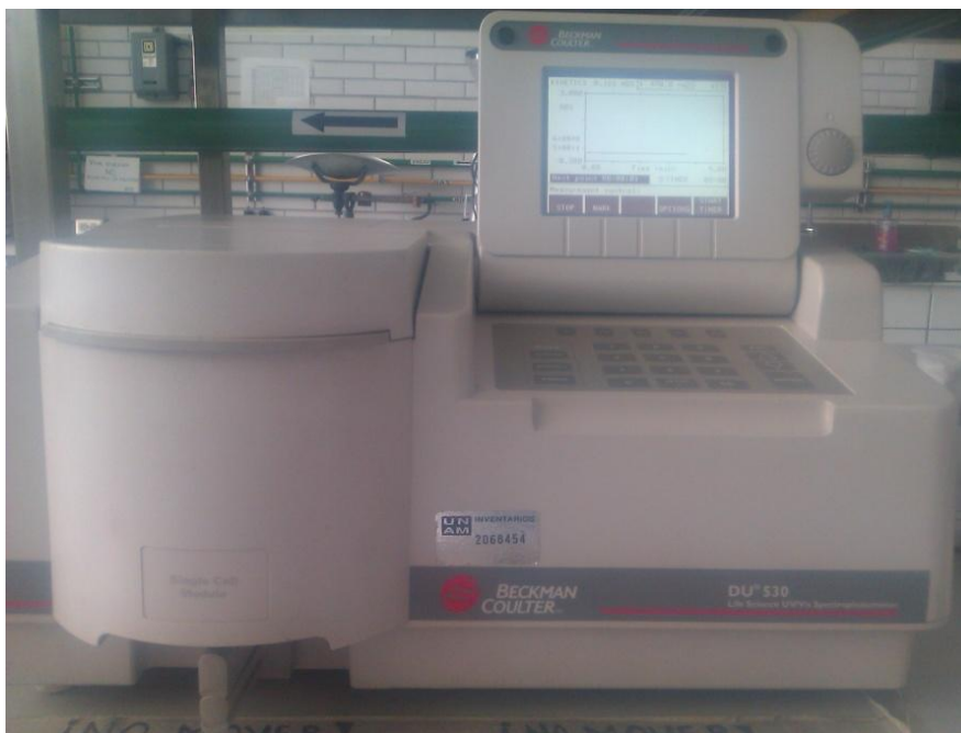
Figura 22. Espectrofotómetro para la determinación de actividad enzimática en semillas de amaranto
