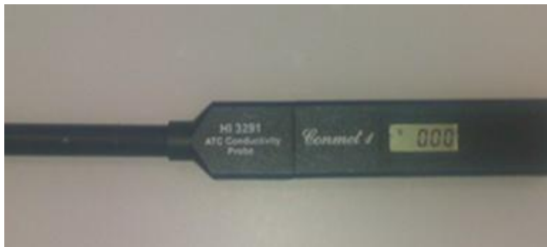
Figura 19. Equipo usado para medir conductividad del agua de remojo de semillas de amaranto
