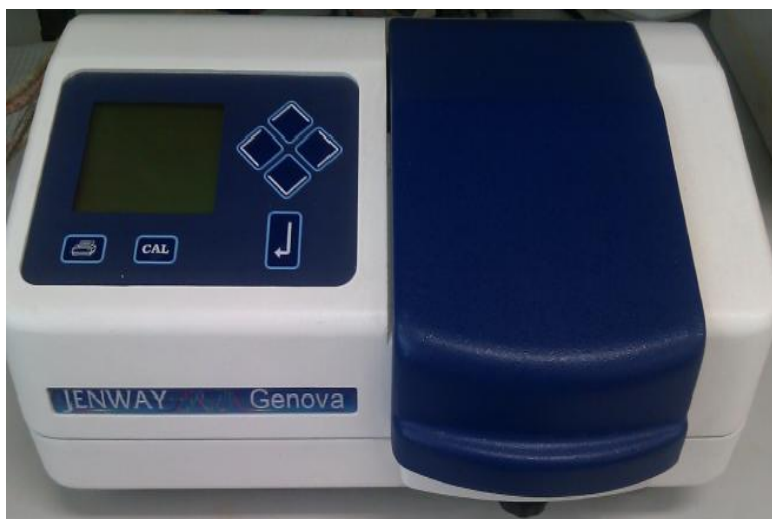
Figura 20. Espectrofotómetro usado para la determinación de malondialdehído y carbonilos en semillas de amaranto
