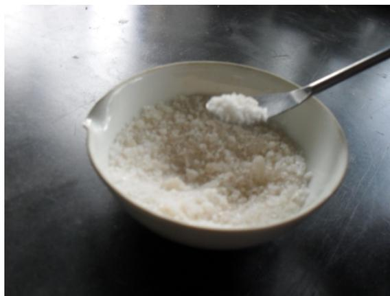
**Figura 2.2. PAA obtenido después del secado.**
