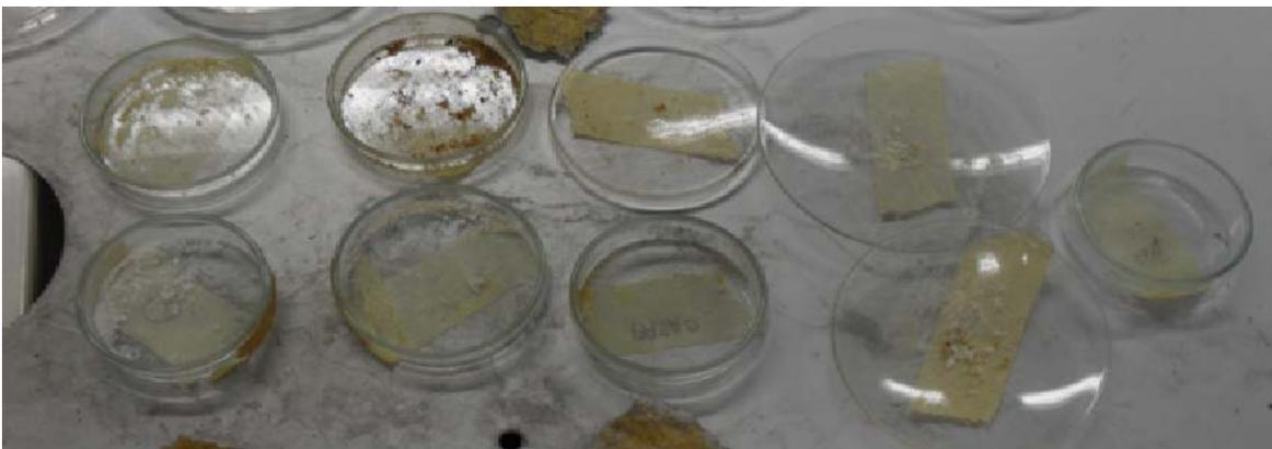
**Figura 3.2. Poli(acrilato de sodio) después de los 75 días de exposición a la luz UV, degradación acelerada.**
