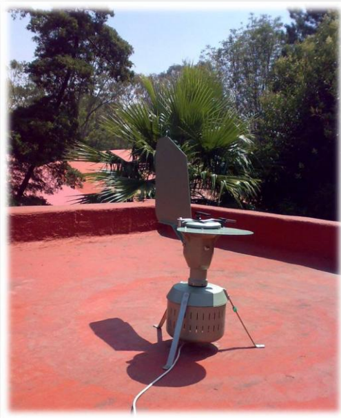
Figura 13. Trampa de esporas tipo Hirst (Burkard) ubicada en la azotea del Museo de Historia Natural, dentro del bosque de Chapultepec.
