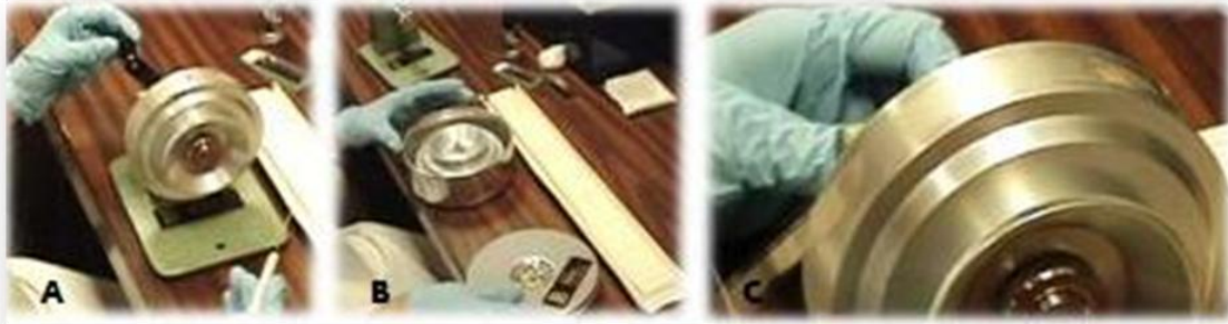
Figura 15. A. Soporte con manivela para tambor. B. Porta tambor metálico-hermético. C. Remoción de la cinta impactada.
