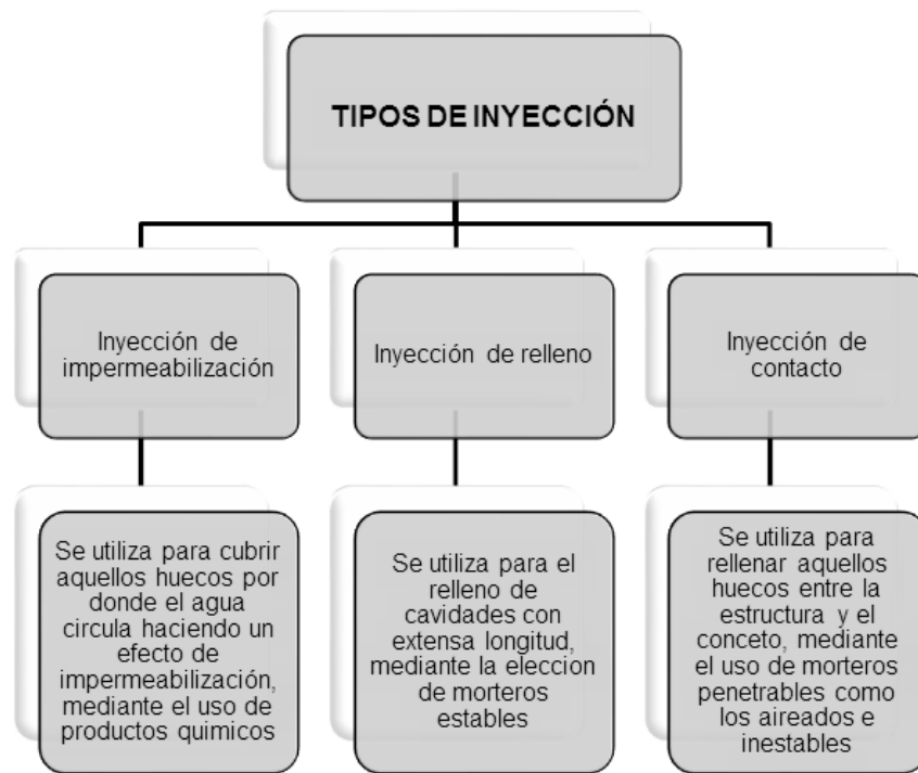
Figura 4.14. Clasificación de los métodos de inyección
