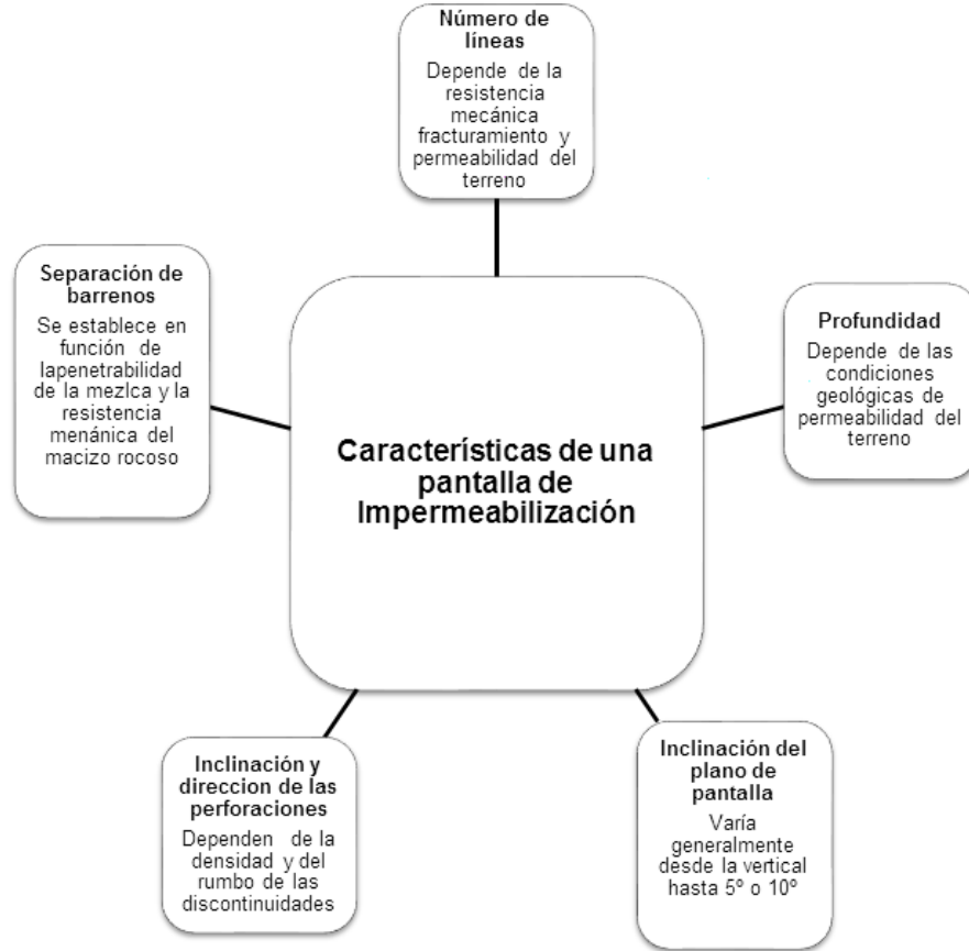
Figura 4.16. Características de una pantalla de impermeabilización
