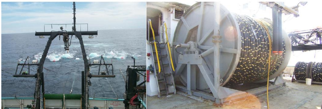
Figura 4.2 Streamer (Fotos tomadas durante la adquisición de perfiles sísmicos durante la Campaña del 2005 en el Cráter Chicxulub).
