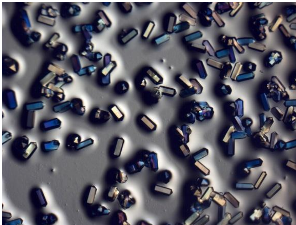
Figura 3. Grupo de cristales microscópicos capaces de atrapar 80 veces su volumen en \text{CO}_2 .
