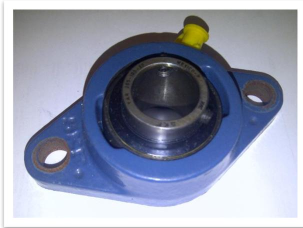
Figura 5.2 Fotografía de unidad de rodamiento.
