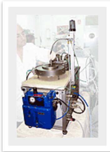
**Figura 2.7** Equipo para ensayos tipo pin on disk.
