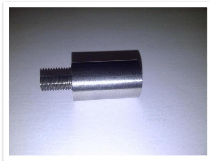
**Figura 5.9** Fotografía de reductor de diámetro.
