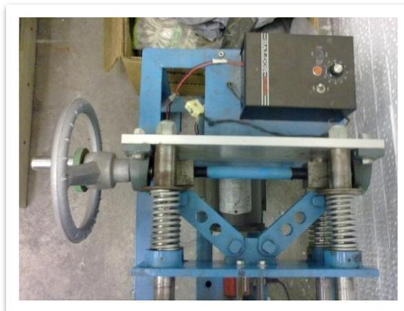
**Figura 3.3** Imagen del mecanismo carga, volante-tornillo de potencia.
