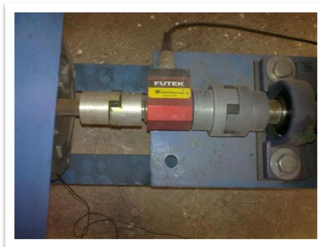
**Figura 3.5** Imagen del sensor de torque y acoplamientos.
