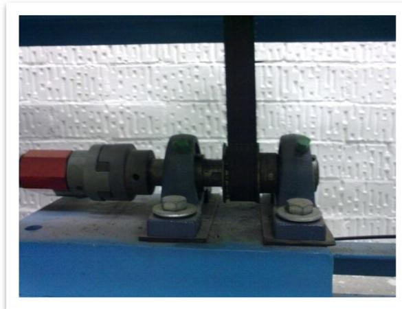
**Figura 3.2** Imagen del mecanismo de transmisión, polea-banda síncrona.
