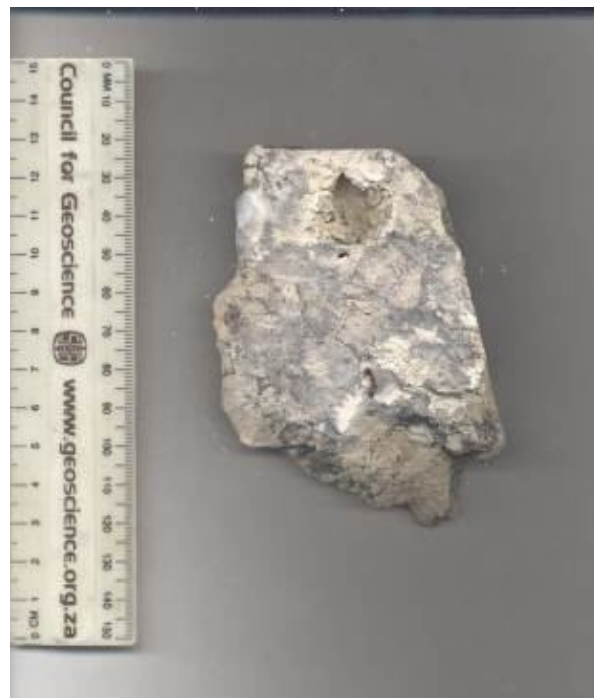
AC-18 C, Muestra obtenida en campo donde se puede distinguir cuarzo y ópalo.
