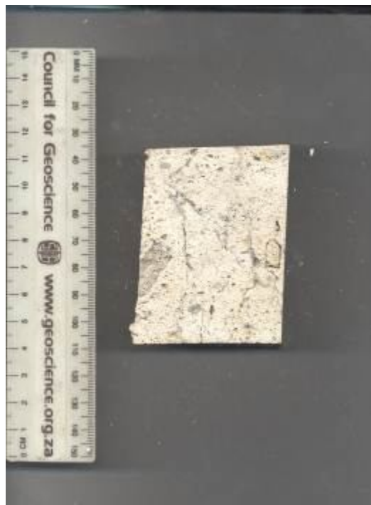
AC-22, Según la firma espectral dio como resultado alunita.
