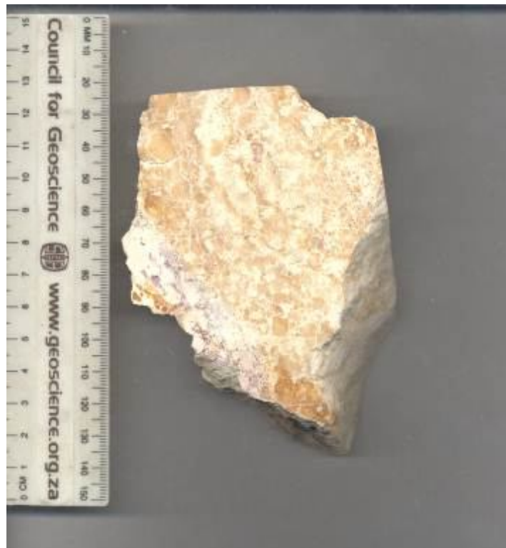
Muestra AC-21A, Según la firma espectral dio como resultado illita/esmectita
