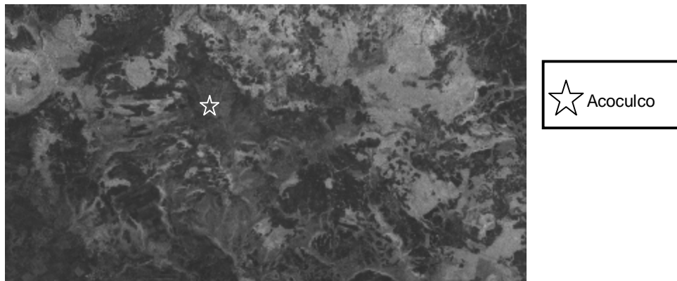
Figura V.6. Resultado de cociente de bandas, imagen Landsat bandas 5 entre 7. Los tonos claros que se presentan al oeste del poblado de Acoculco, coinciden con los hidroxilos localizados con la técnica de falso color.
