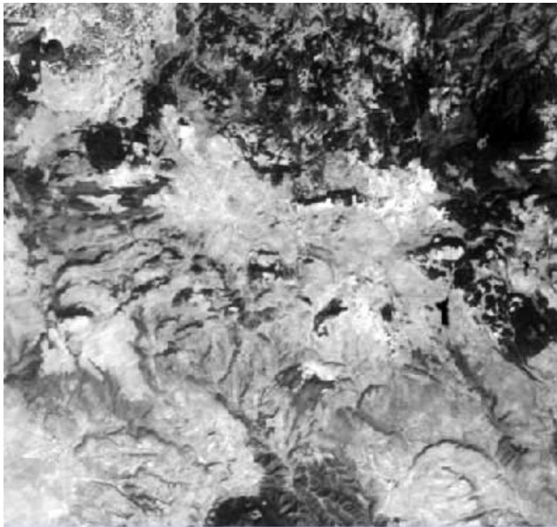
Figura V.8. Cociente de bandas 5,6,7 y 8 de la imagen, ASTER. La imagen muestra un cociente de bandas en donde resaltan los óxidos con tonos claros (valores cercanos a 255).
