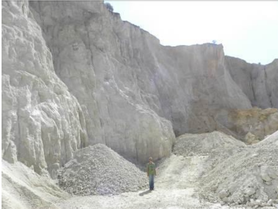
AC-22, Cantera, donde explotan arena silica, existen piedras pómez y ceniza de color predominantemente blanco, también se observa una zona color amarilla próxima a una oxidación.
