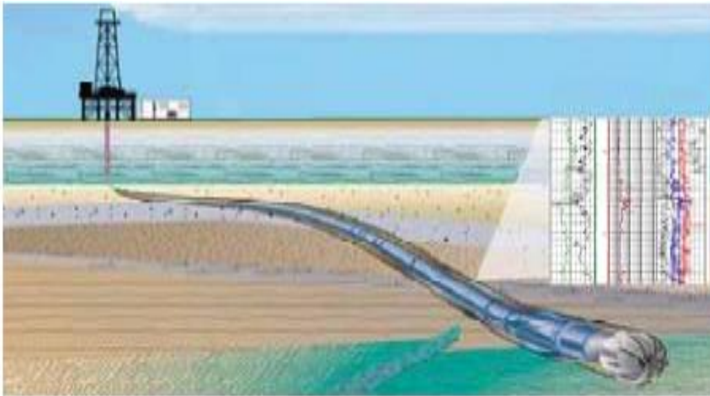
Figura 3.10 Representación de la toma registros geofísicos en Perforación (OSchlumberger, 2003).
