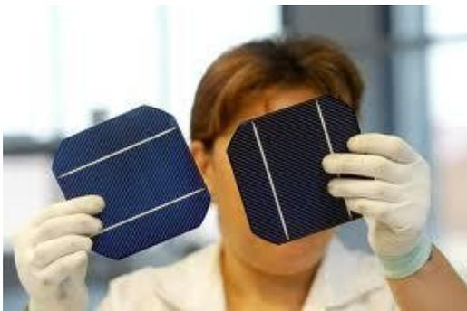
**Figura 2.22 Células fotovoltaicas utilizadas en la fabricación de los paneles solares**
