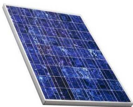
En este caso el proceso de cristalización del silicio es diferente. Los paneles policristalinos se basan en secciones de una barra de silicio que se ha estructurado desordenadamente en forma de pequeños cristales. Son visualmente muy reconocibles por presentar su superficie un aspecto granulado. Se obtiene con ellos un rendimiento inferior que con los monocristalinos (en laboratorio del 19.8% y en los módulos comerciales del 14%) siendo su precio también más bajo. Ver figura 2.9
