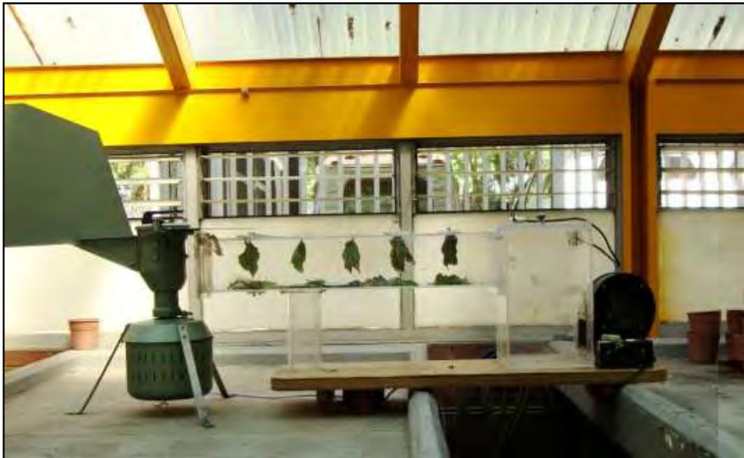
Figura 15. Minitúnel de viento con hojas infectadas con roya asiática. Las urediniosporas liberadas por la corriente de aire fueron colectadas con la trampa de esporas tipo Hirst.
