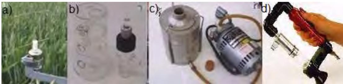
Figura 9: Muestreadores utilizados en Aerobiología: a) muestreador de brazo giratorio (Rotorod), b) impregnador en líquido de varias fases, c) muestreador de partículas viables (Andersen), d) muestreador ciclón de superficie (Burkard).
