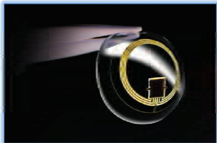
*Figura 3. 18 Sistema de retina artificial completo con el acoplamiento de la antena RF y el estimulador TES*
