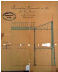
Figs. 270 y 271. Corte de la estructura metálica del pabellón mexicano en París, enviado por la empresa Baudet Donon & C.ie (izq.). Sello de la empresa Henri Roussel (der.) En: AGN, Fondo Exposiciones internacionales, caja 32, exp. 2
