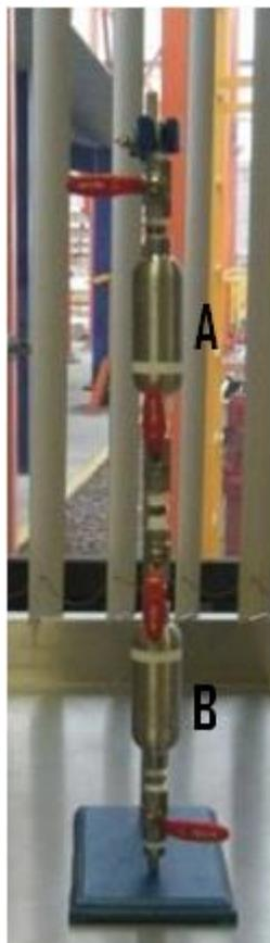
*Figura 7.* Fotografía que muestra unión de dos balas en vertical para la preparación de las muestras. Bala A contiene el gas butano limpio. Bala B contiene los estándares de BTEX para mezclarse con el butano limpio.
