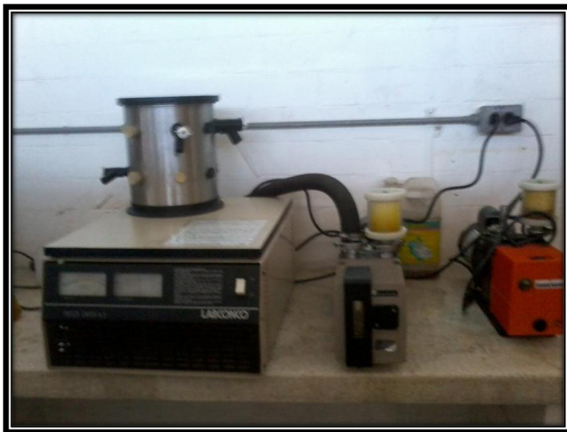
**Figura 4.** Equipo Liofilizador LABCONCO de la Facultad de Química, anexo del Laboratorio 4-A.
