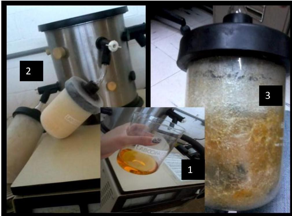
**Figura 8.** Muestra el proceso de liofilización del extracto acuoso de manzana Royal gala, 1 muestra líquida, 2 muestra congelada, 3 muestra liofilizada.
