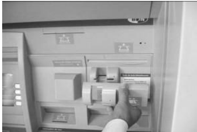
Figura 2.15 Lector magnético falso
