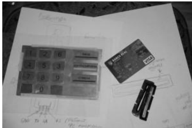
Figura 2.13 Teclado falso de cajero automático
