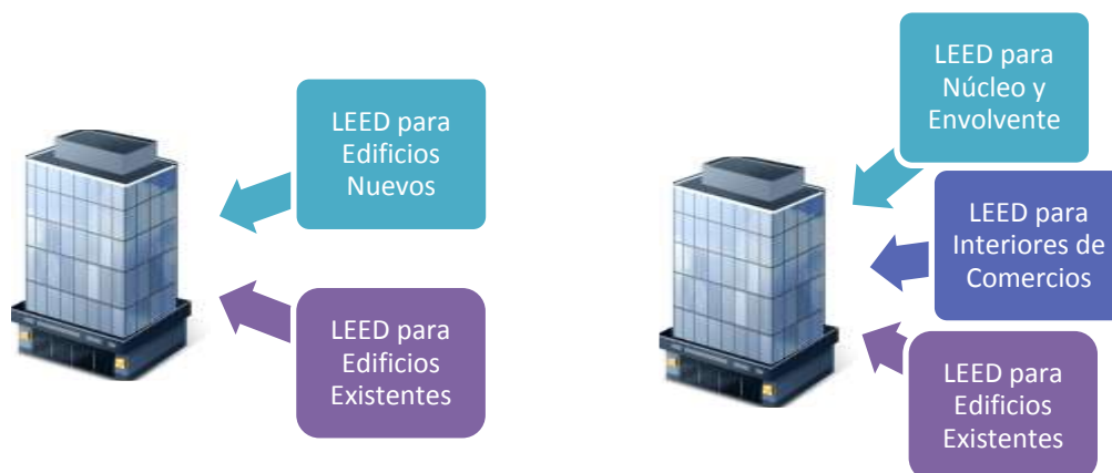
Figura 3.12: Ejemplos de múltiples certificaciones LEED para un edificio.
