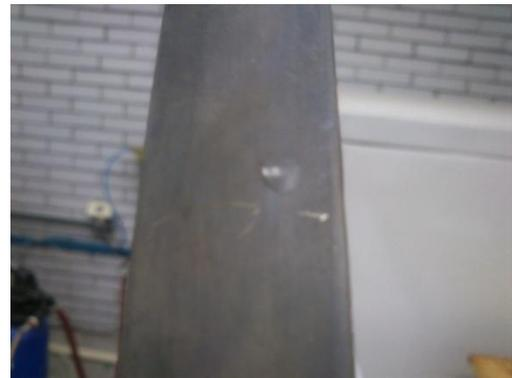
**Figura 5.12** Ampolla en muestra acero P110 de prueba 1
