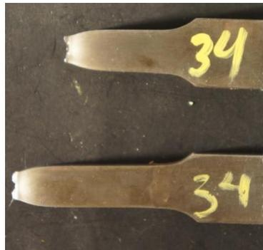
b) Probeta ensayada a tracción
