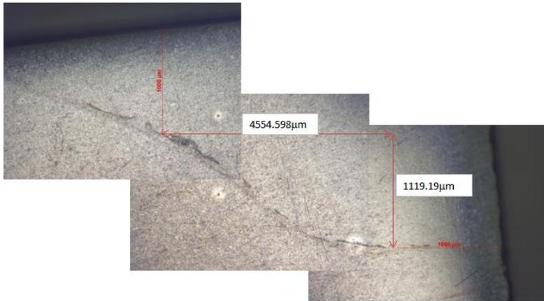
Fig. B2 Grietas en sección 1102
