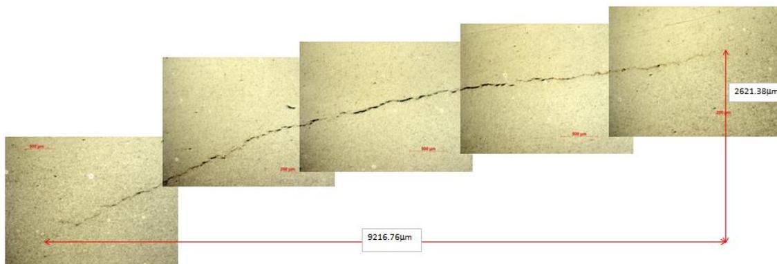
Fig. B30 Grieta en sección 2302
