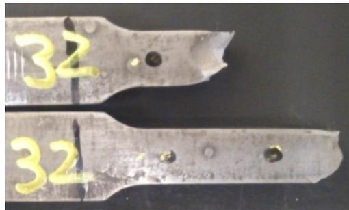
b) Probeta ensayada a tracción
