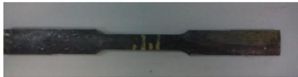
**Figura 4. 5 Muestras de acuerdo a la norma ASTM E8M**
