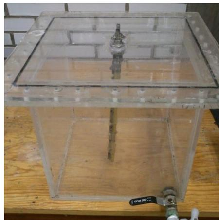
**Figura 4. 9 Celda de 8mm de espesor**
