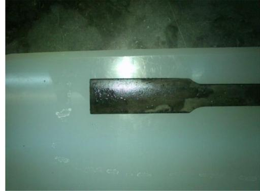
**Figura 5.10** Capa de residuo en una muestra de P110
