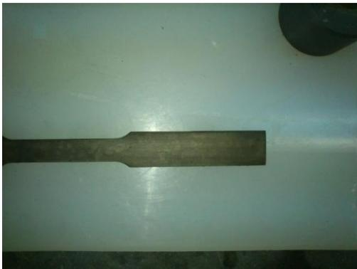
**Figura 5. 11** Capa de residuo en una muestra de T95
