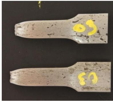
b) Probeta ensayada a tracción
