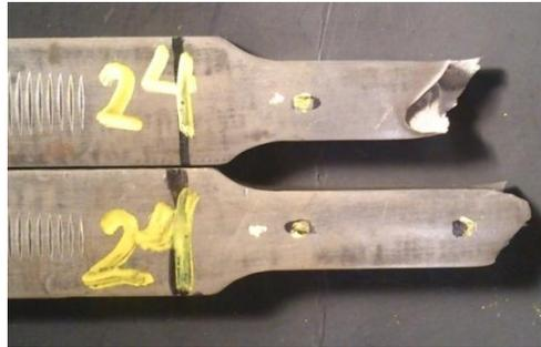
b) Probeta ensayada a tracción
