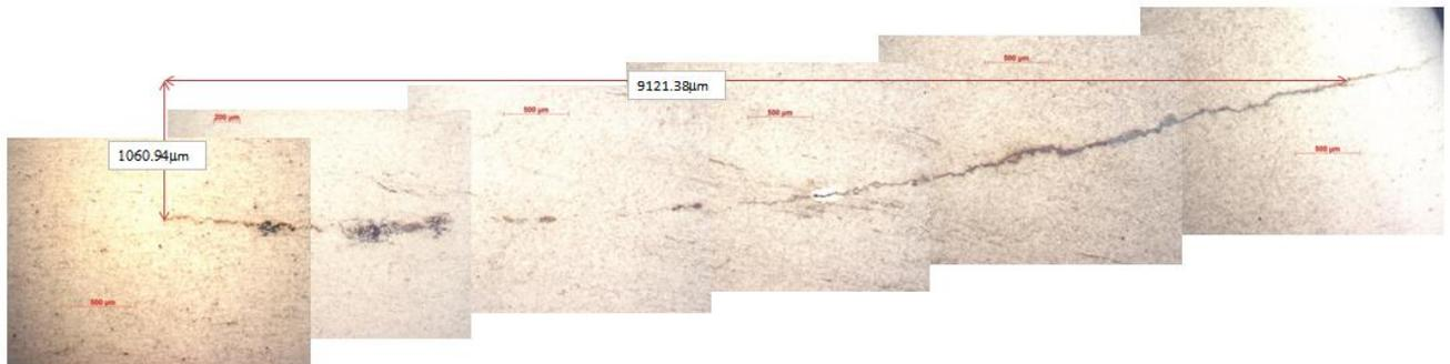
Fig. B5 Grieta 2 en sección 120
