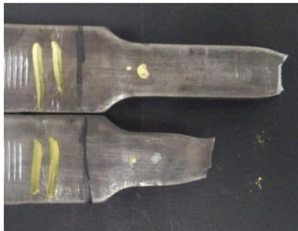
b) Probeta ensayada a tracción
