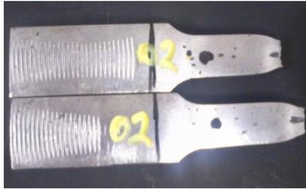
b) Probeta ensayada a tracción
