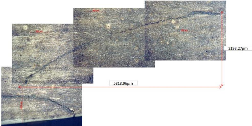
Fig. B78 Grieta 4 en sección 3304
