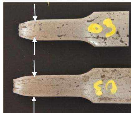
Figura 5.20. Medición de reducción de área.
