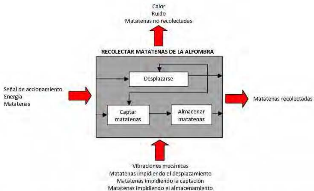
Figura 3.3.1 Función principal recolectar matatenas de la alfombra, vehículo que almacena matatenas.
