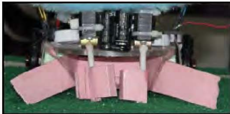
Figura 4.2.4 Roce entre aspas rotatorias y alfombra.
