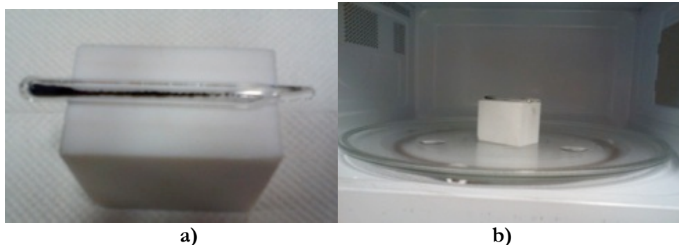
Figura 3.9. a) ampolleta colocada en base de teflón; b) muestra colocada dentro del horno.
