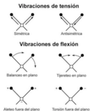
Figura. 1.11. Modos de vibración de moléculas por espectroscopía IR
