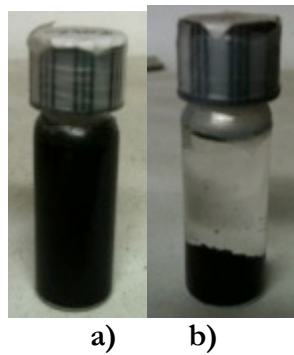
Figura 4.17. NTCPM prístinos a) 1hr después del baño ultrasónico, b) 24hrs después del baño ultrasónico.
