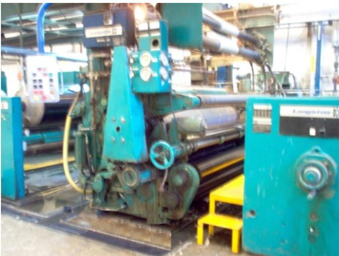
En la sección del cabezote, se fabrica el corrugado cara sencilla Cuenta con dos rodillos corrugadores que tiene la forma de la flauta y al pasar el rígido entre ellos hacen la formación de ésta. Un rodillo de presión que ayuda a realizar el pegado del papel liner con el rígido a altas velocidades. Un rodillo engomador el cual se encarga de realizar la aplicación de adhesivo en la cresta de la flauta del rígido. Un rodillo dosificador o
