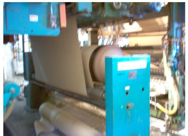
(de 30 a 50 kg/cm lineal). Los rodillos onduladores aseguran el moldeado del papel. El perfil de las ondas de estos define el perfil del ondulado y, por consiguiente, el tipo de canal. Los rodillos deben estar contruidos con aceros forjados y perfectamente estabilizados. Después de su formación, se mantiene el canal contra el rodillo inferior (rodillo de presión) mediante un dispositivo de aspiración o de presión de aire.
