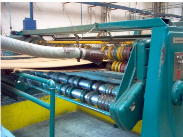
La sección de triplex contempla el marcado y cortado el ancho del pliego requerido, el triplex se subdivide en tres secciones y cada sección cuenta con cuatro barras, sobre las cuales se encuentran colocadas las cuchillas de corte y los marcadores de dobléz. En cada sección se pueden colocar medidas para una o dos laminas.
