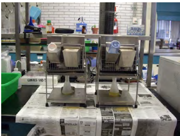
Fig. 3. Cajas metabólicas para la recolección de orina, cuantificación de alimento y agua.
