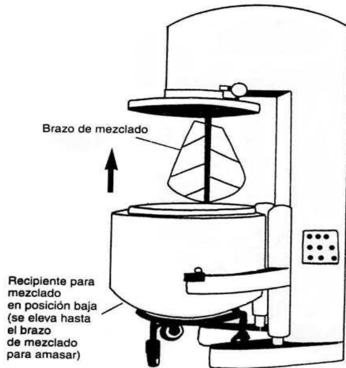
Ilustración 8. Mezclador planetario para amasado húmedo. (Aulton, 2002).
