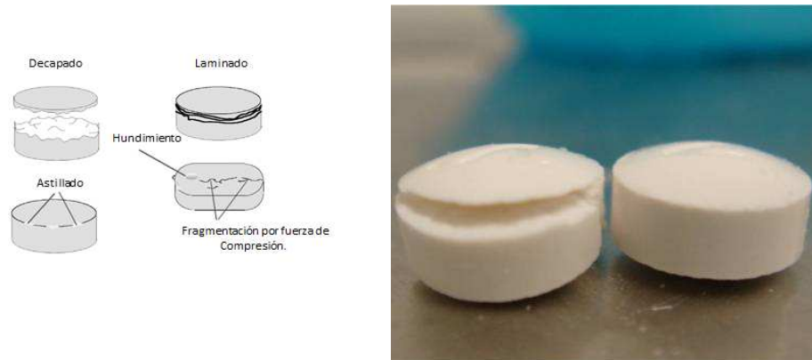
Ilustración 17. Defectos de los comprimidos conocidos como decapado y laminado. http://techceuticals.com/blog/ y FMC Solver Problem, 12 de Octubre 2012.
