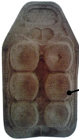
Modelado con pulpa de celulosa (material virgen con carga de permanganato de potasio)
