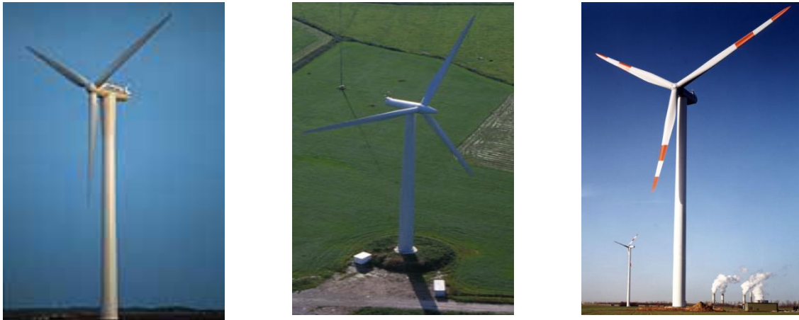
Figura 3.5.- A la izquierda NEG Micon 1,5 MW, al centro Bonus 2 MW, a la derecha Nordex 2,5 MW. Estos modelos debido a su gran capacidad poseen torres con una altura que supera los 80 metros de altura.
