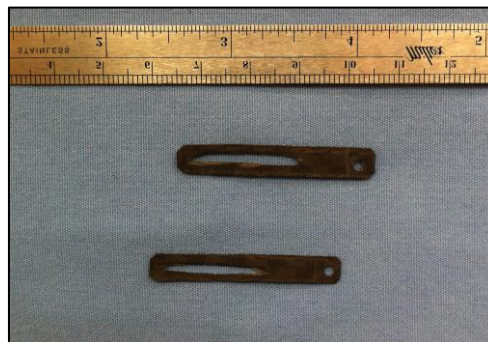
Figura 5: ARRIBA prototipo de fibra de carbono de 0.6 mm de espesor. ABAJO prototipo de fibra de carbono de 0.4 mm de espesor
