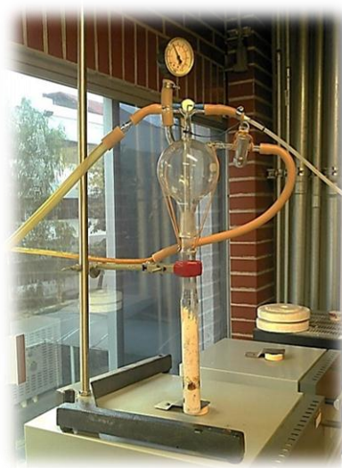
Figura 5.1 Dispositivo sinter II , el cual cuenta con sistema de vacío, válvula de tres vías y manómetro.
