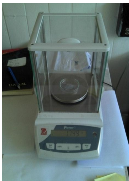
Figura 4.1 Fotografía de la balanza analítica marca Ohaus, modelo Pioneer utilizada para obtener todos los pesos tanto de polvos, compacto en verde, espuma sin material de sacrificio y espuma metálica de Al.
