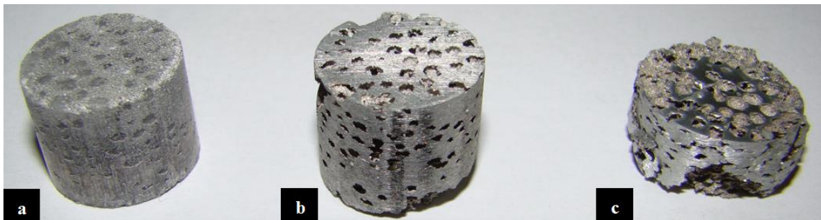
Figura 4.3 Fotografías de las muestras en las diferentes etapas del proceso de producción de espumas metálicas de Al. a) Después de la compactación, b) Posterior al proceso de sinterización y c) Muestra después de la caracterización de propiedades mecánicas a compresión.
