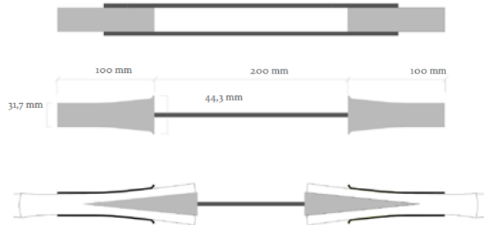
Imagen 5.5, Nodo de Tenso-Estructura, Fuente: Mtro. Daniel Buzeta Busquets, Tesis: "ARQUITECTURA EN BAMBU, El Colihue como Elemento Resistente en Tenso-Estructuras", Chile, Pontificia Universidad de Chile. 2005. pp. 97
