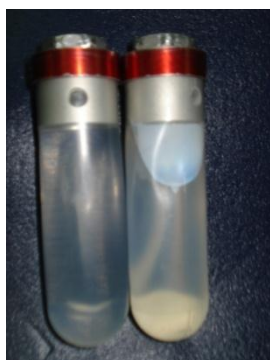
Figura 16. Características de las partículas obtenidas a partir del método de doble emulsión con la modificación del empleo de un disolvente parcialmente miscible. En la parte izquierda se muestra el tubo con agua utilizado con referencia y en la derecha se observa el tubo en donde se aprecia la presencia de dos tipos de partículas, unas de baja densidad que flotan en la parte superior mientras que otras quedan formando parte de la pastilla.
