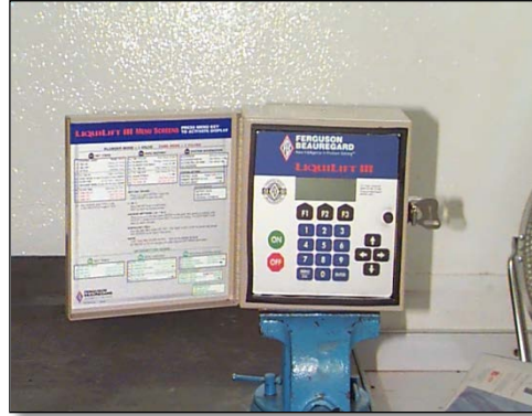
Fig.2.1g. Controlador de Ciclos para Bombeo Neumático Intermitente.
