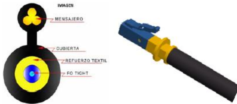
Figura 3.7 Cordón de Acometida óptico Preconectorizado.
