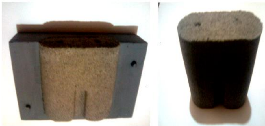
Figura 3.4 corazón moldeado y fraguado
