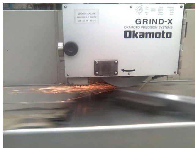
Figura 3.12 Rectificado de la tapa del dispositivo
