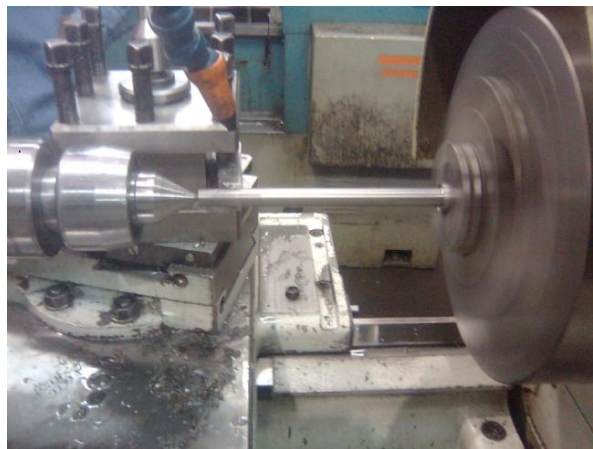
Figura 3.14. Maquinado de punzones entre puntos.
