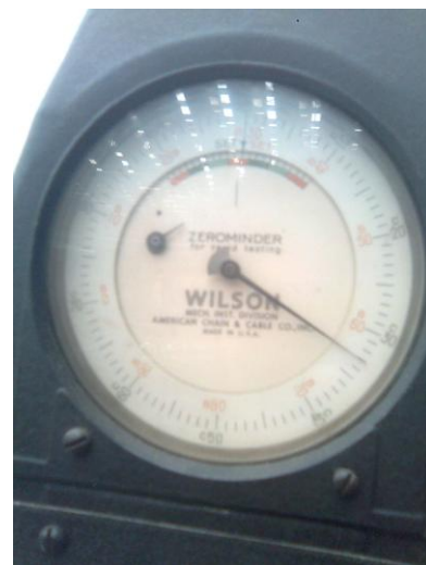
Figura 3.20. La dureza del punzón después de haber sido templado fue de 35 RC
