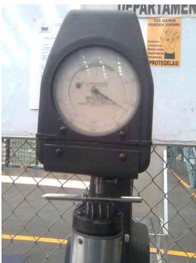
Figura 3.20. La dureza del punzón después de haber sido templado fue de 35 RC
