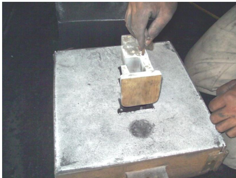
Figura 3.6. Se retira el modelo para formar la cavidad
