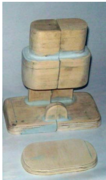
Figura 3.2 Modelo del cuerpo y tapa
