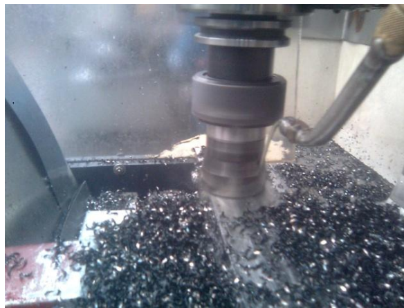
Figura 3.11. Fresado de la base del dispositivo marcador de probetas
