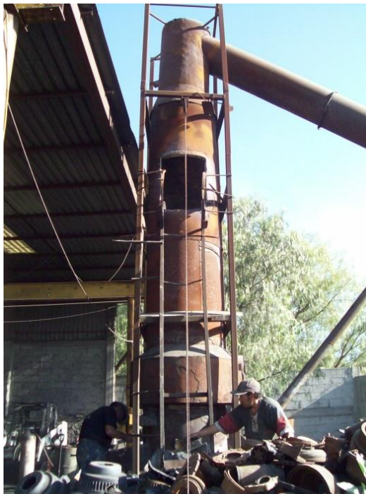
Figura 3.7. Horno de cubilote
