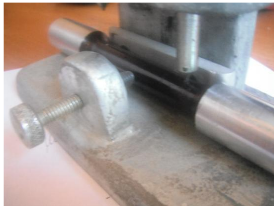
Figura 4.4 Probeta posicionada e inmovilizada
