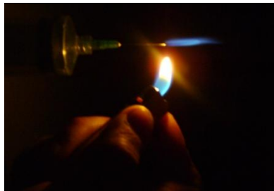
Figura 3.7 Pruebas de inflamabilidad a biogás
