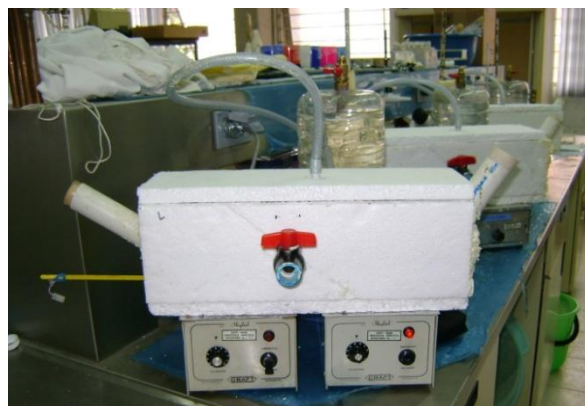
Figura 3.5 Reactor anaerobio de flujo pistón envuelto con láminas de unigel
