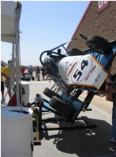
Imagen 3.1 Prueba de inclinación a 60°
