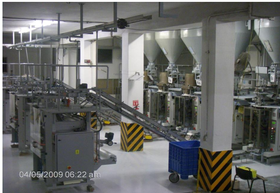
Empresa Detergentes y Jabones Sasil, S.A. de C.V. Planta Monterrey, máquinas envasadoras Guerze, tolvas de alimentación y enfardadoras Raumack, Mayo 2009.
