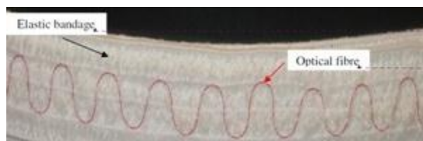
Figura 23. Fibra óptica dentro de un vendaje elástico
