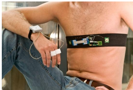
Figura 14. Ejemplo de montaje de los nodos sensores
