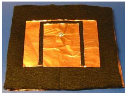
Figura 43. Antena de doble banda fabricada de lana con frecuencias de operación de 1.9 y 2.4 GHz
