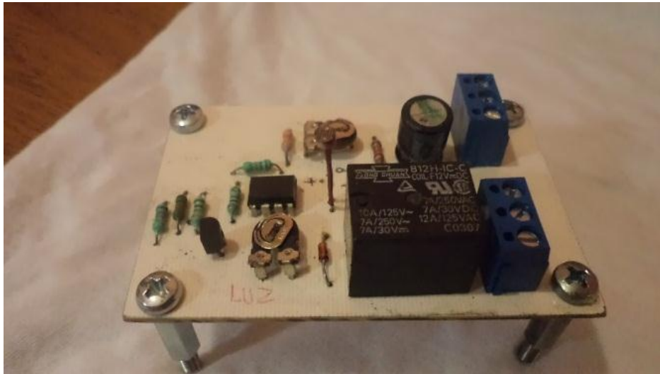
Ilustración 46. Circuito en tablilla de sensores de luz y temperatura.
