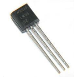
Ilustración 13. Encapsulado Sensor térmico LM35
