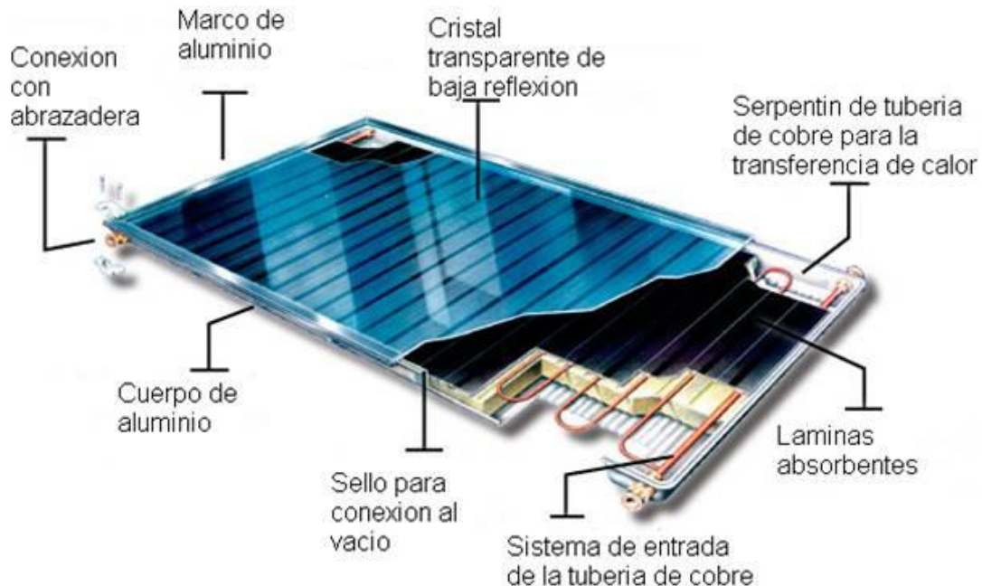
33 Fig. 4.7. Esquema general de un colector plano.
