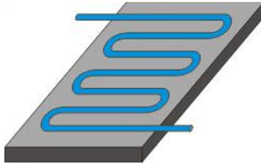
30 Fig. 4.4. Disposición de la tubería de vidrio en forma de serpentin.
