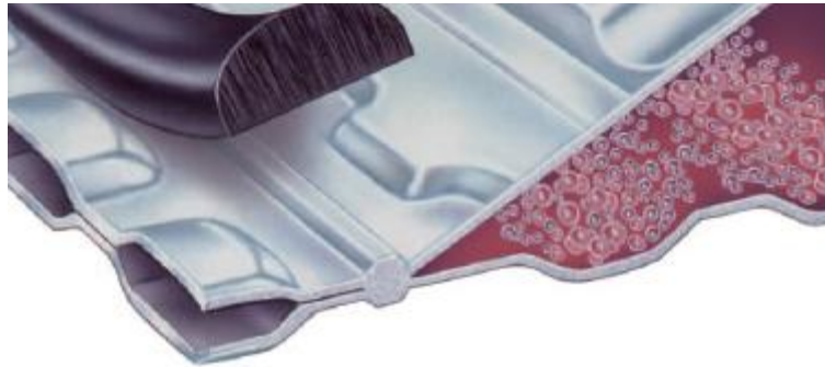
Figura 5. Sección de un intercambiador de calor de placas soldadas y unidas por empaques 5 .
