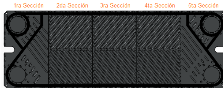
Figura 21. Diferentes secciones de una placa utilizada modelada.
